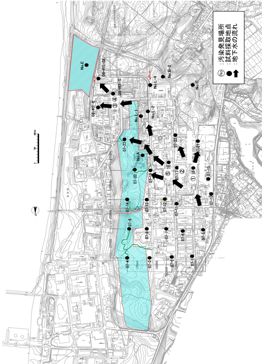
図 2.4.5-1 非管理区域において汚染が発見された場所及び地下水試料の採取地点
